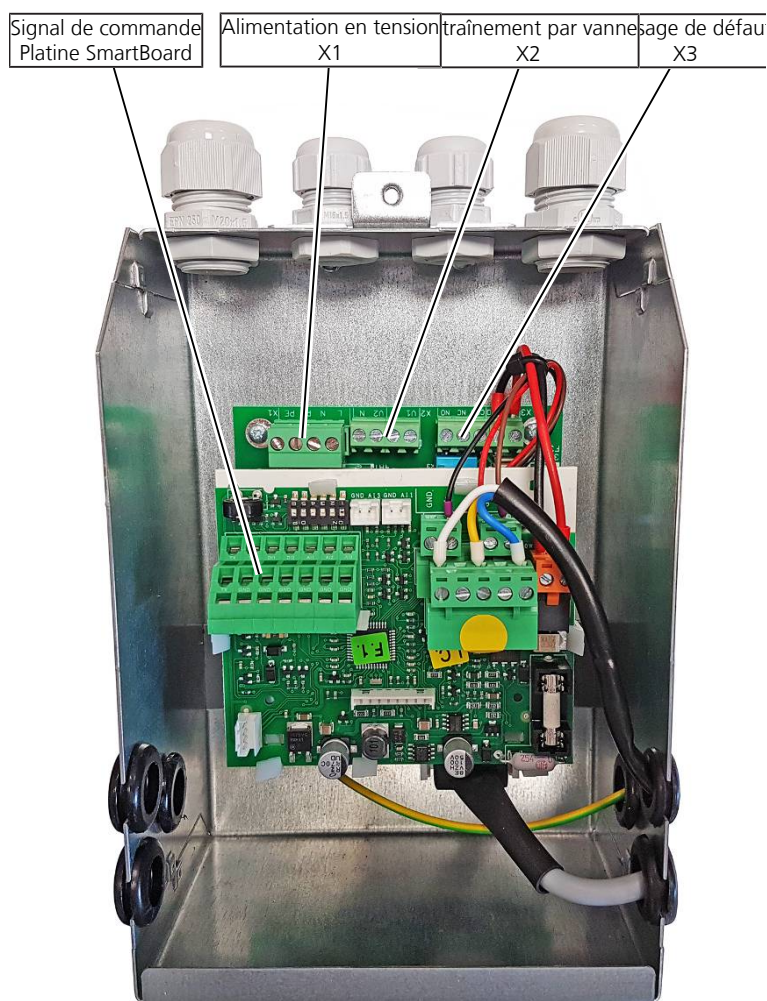
III. : 27: Platine avec boîte de raccordement électrique
