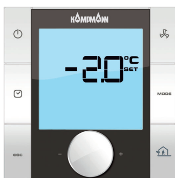
Paramétrage du décalage de la température de consigne
