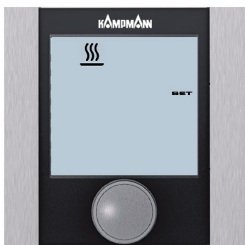
Réglage du mode d'exploitation Hiver
