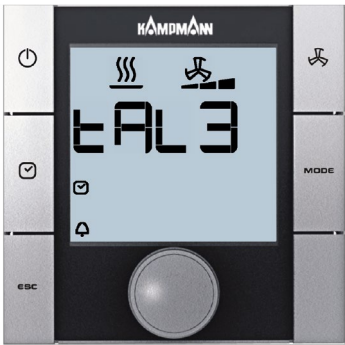
Affichage «Alarme de condensat» (Exemple alarme A14)
