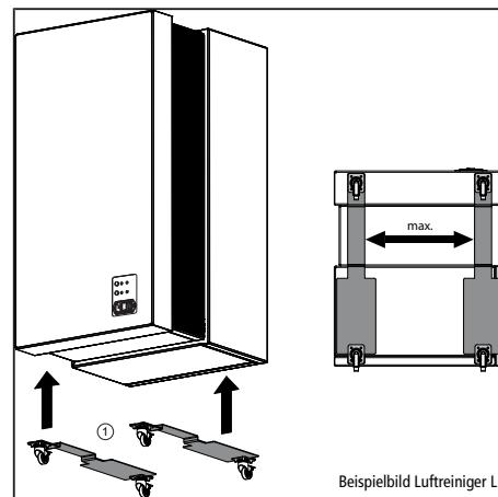
Coller les roulettes ① (accessoire) prémontées en option sur de la tôle sur le dessous de l'appareil.
